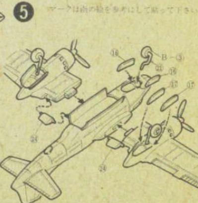
翼と車輪カバーを接着します
