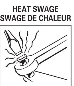
When heat swage is indicated, heat the tip of the knife in a candle or match flame. When touched to the plastic, the plastic will soften and form a "mushroom" head. / Lorsque le thermocollage est indiqué, chauffez la pointe du couteau dans une bougie ou une allumette. Lorsqu'il touche le plastique, le plastique se ramollit et forme une tête de «champignon».
